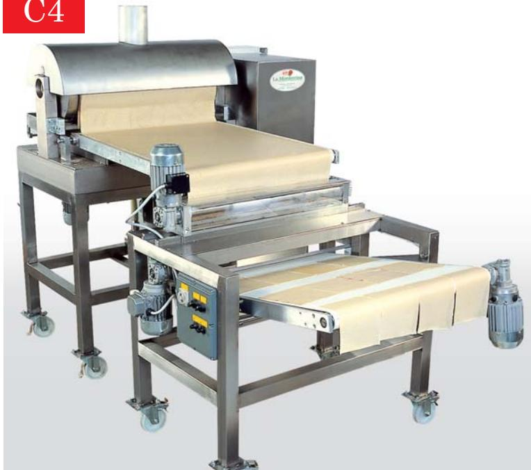
La macchina si completa con un GRUPPO DI TAGLIO che permette di tagliare il foglio di mm 640 in senso longitudinale e trasversale.
